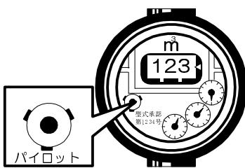
漏水しているときは、市指定給水装置工事事業者に至急連絡して、修理してください。
